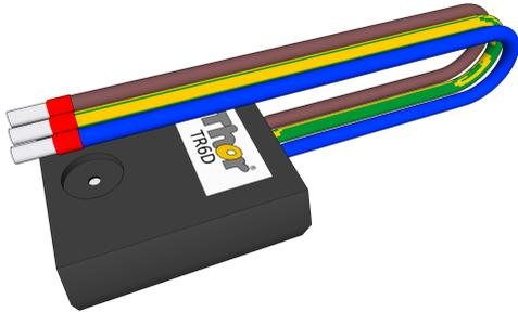
2-poliger Überspannungsableiter Typ 3 (Feinschutz) zum Einbau in tiefe Schalter-, Abzweigboxen oder direkt an die Spannungsversorgungsklemmen von Steueranlagen.
